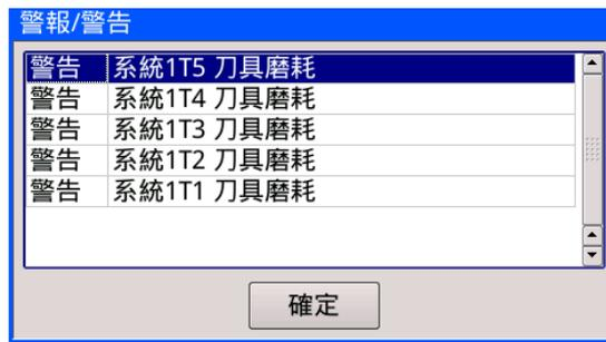
6. 破損：設定破損閾值，數值單位以百分比(%)表示，表示範圍為 0~400。設定刀具功能為監控，並且將控制器切換至自動模式進行啟動加工，當負載值大於或等於破損閾值，刀具狀態會變更為“刀具破損”並顯示警報訊息框，最大警報訊息數量為 5 筆，此時加工動作會被暫停。警報解除與重新啟動加工的方法可參考刀具壽命管理。
